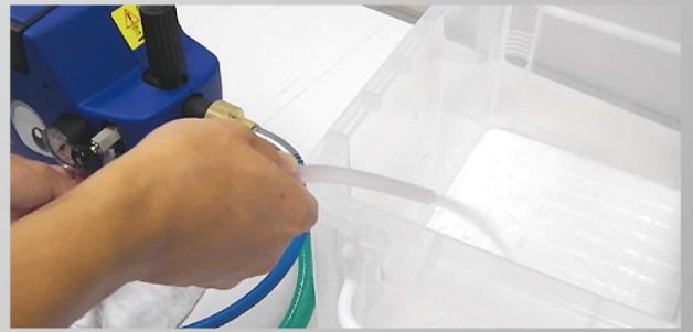
余水ホースを本体に繋ぐのは機械を作動させた時のみでOK。エア抜きが完了すれば余水ホースは取り外します。動力噴射機のようにタンクに常に余水を戻す必要がありません。
