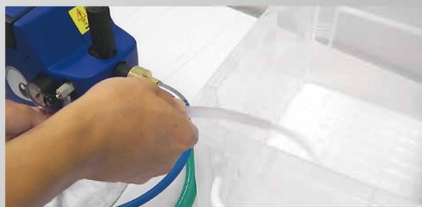
余水ホースを本体に繋ぐのは機械を作動させた時のみでOK。エア抜きが完了すれば余水ホースは取り外します。動力噴射機のようにタンクに常に余水を戻す必要がありません。
